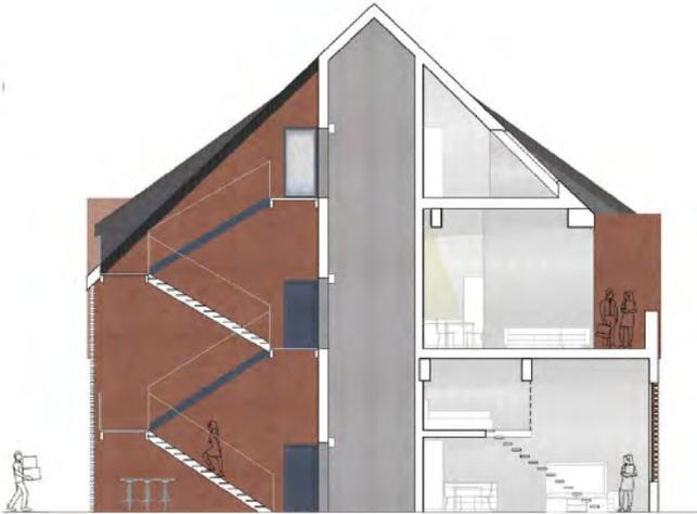
Querschnitt Erschließung Doppelschotte
